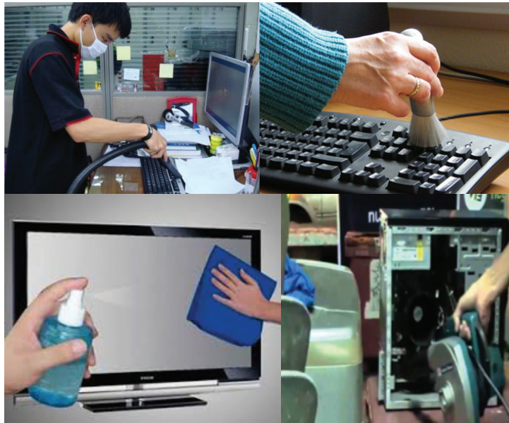
ภาพที่ ๓๑ แสดงวิธีการตรวจซ่อมบำรุงรักษาอุปกรณ์ที่ใช้งานในระบบ CRIMES
